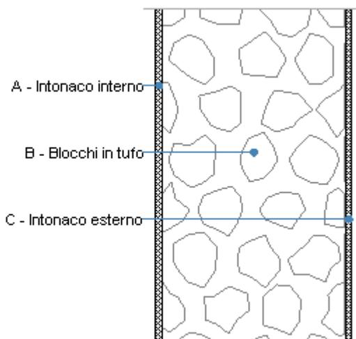
Le proprietà termiche dell'elemento opaco sono valutate in base alla UNI EN ISO 6946.
