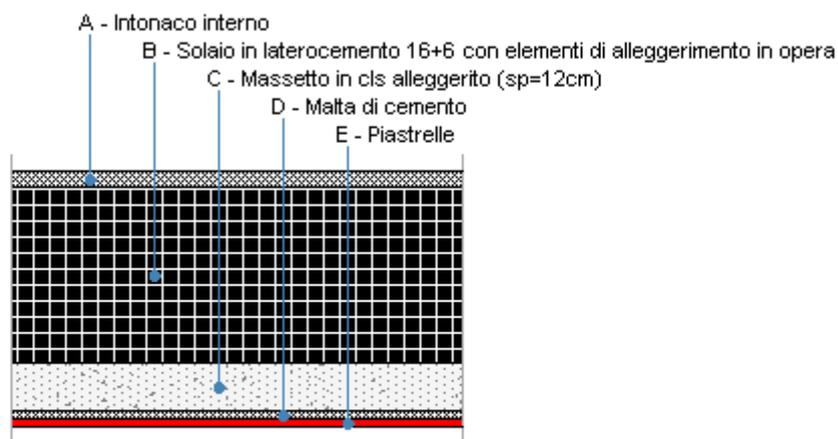
Le proprietà termiche dell'elemento opaco sono valutate in base alla UNI EN ISO 6946.
