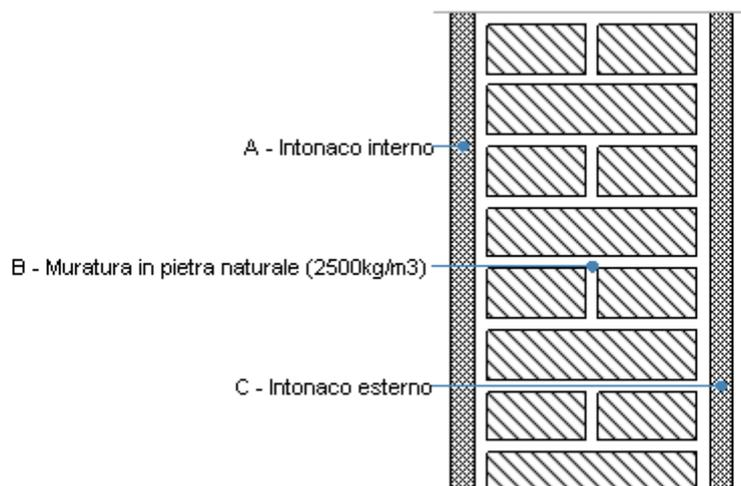
Le proprietà termiche dell'elemento opaco sono valutate in base alla UNI EN ISO 6946.
