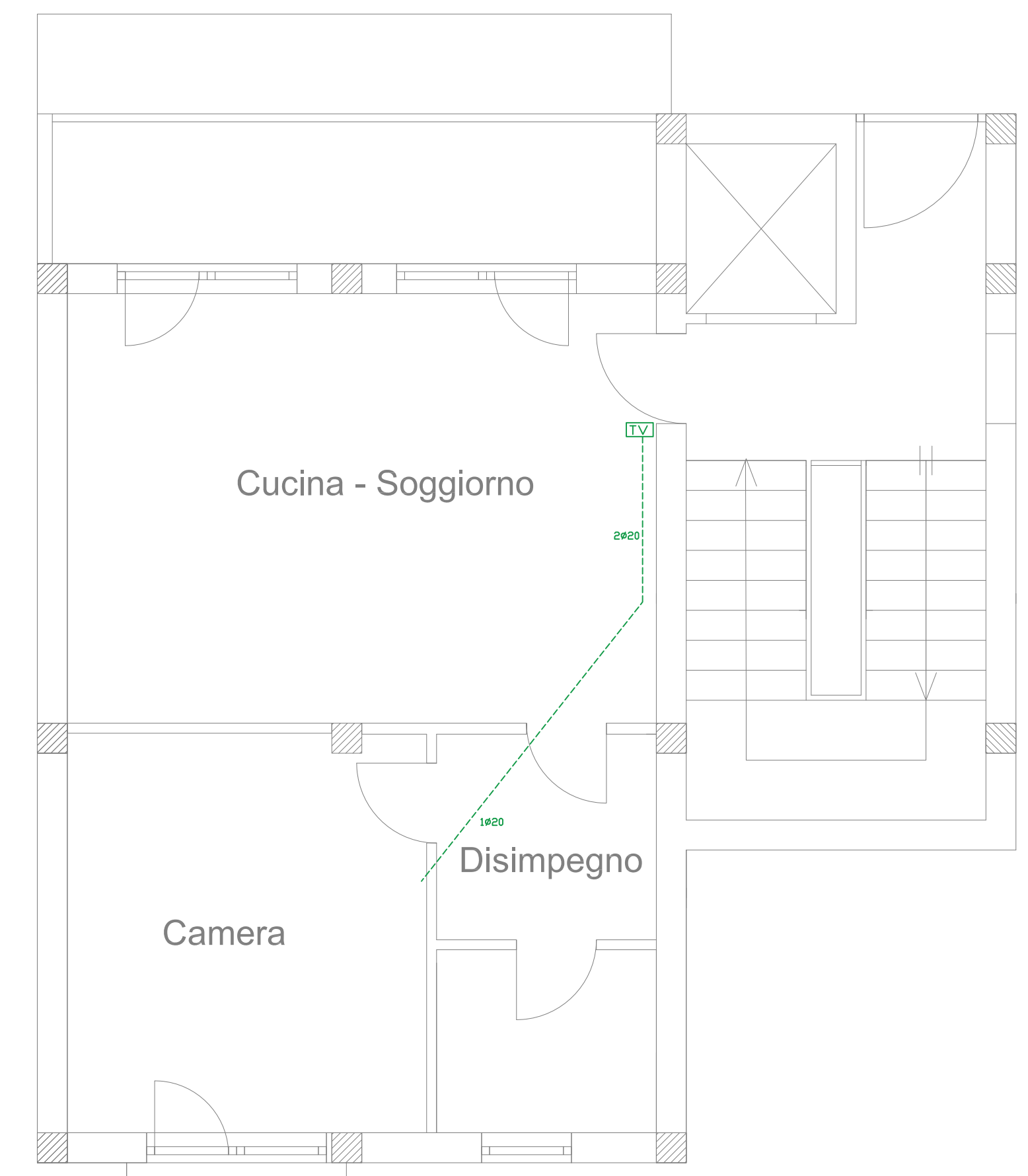
POSIZIONAMENTO SCHERMATURE CAVI ANTENNA STATO DI PROGETTO Scala 1:50
