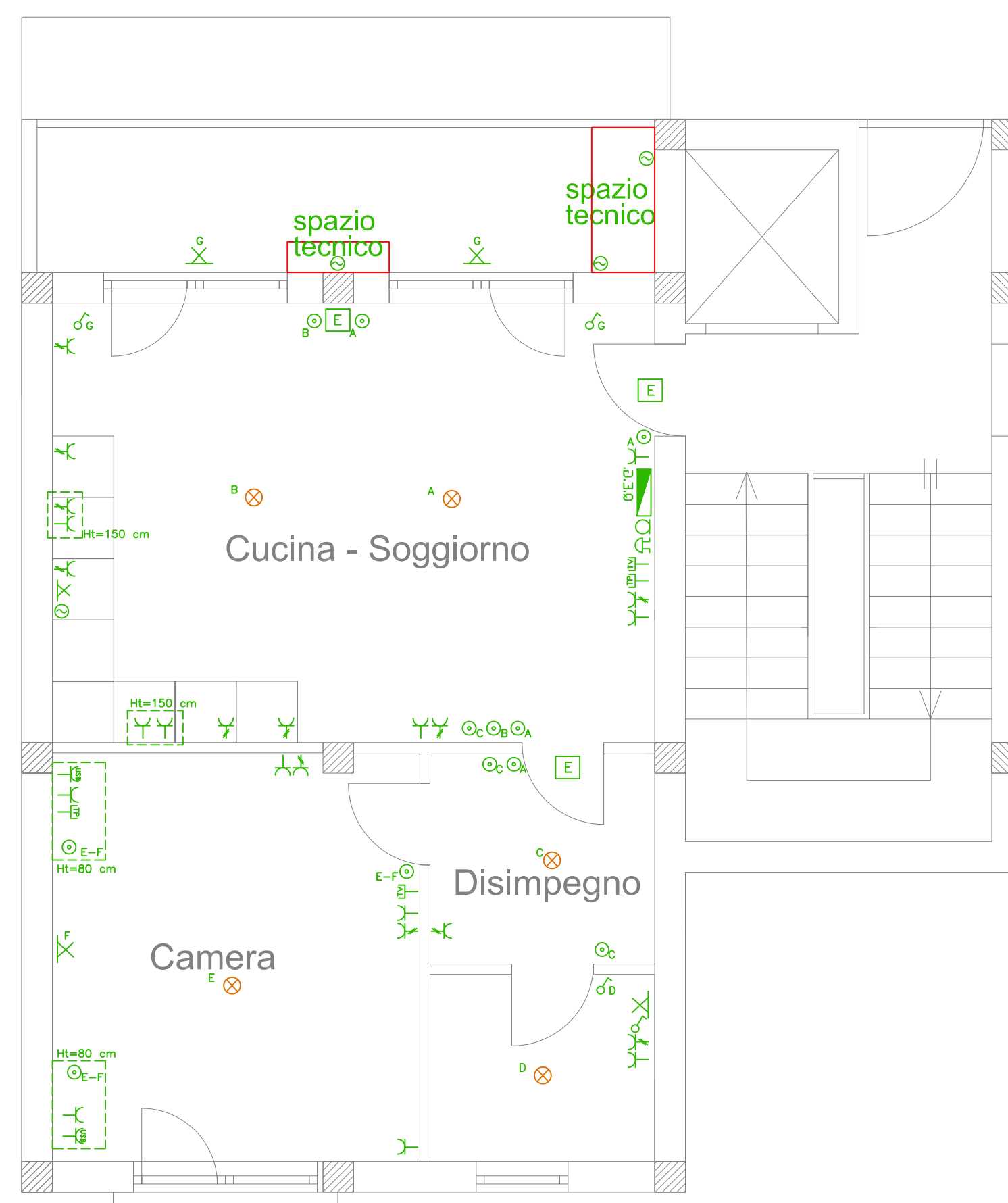
POSIZIONAMENTO PUNTI LUCE E PRESA STATO DI PROGETTO Scala 1:50
